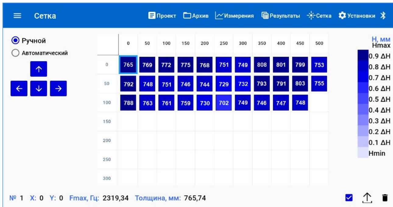
Рисунок 24 – Экран вывода карты границ раздела слоев измеренных толщин
