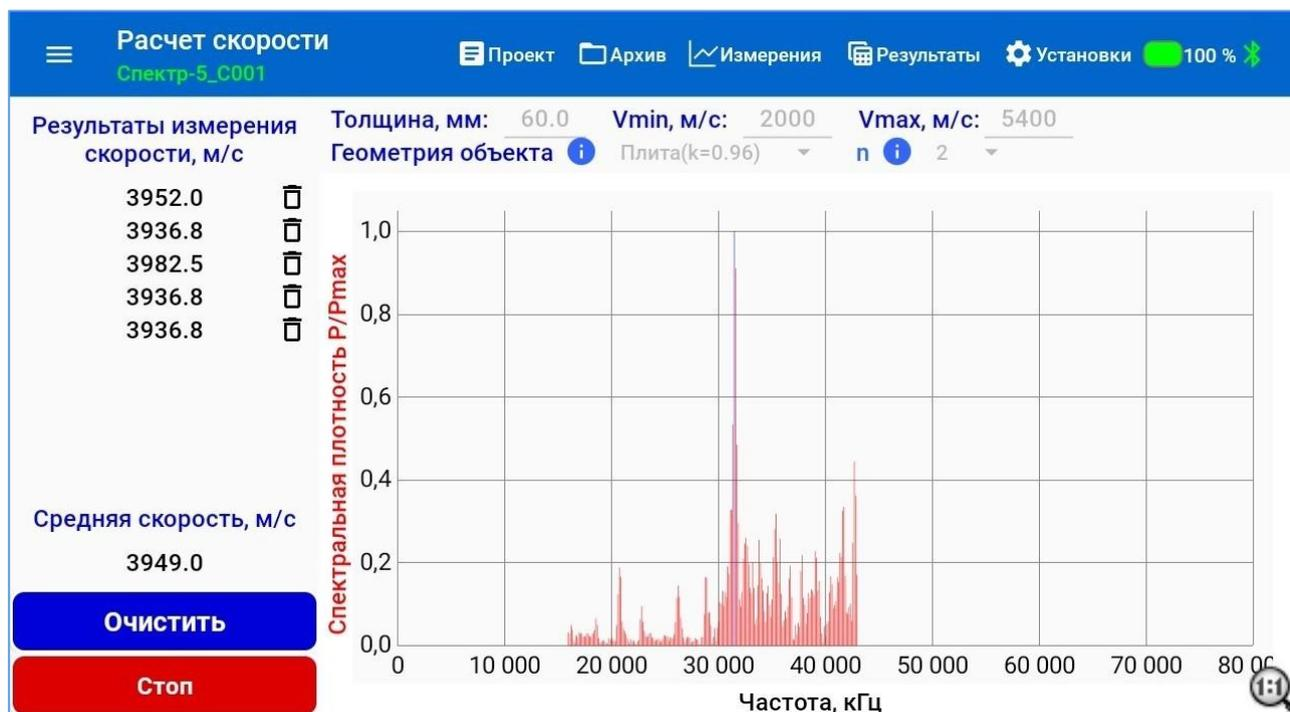
Рисунок 33 – Экран вывода графика спектральной плотности сигнала в режиме «Расчет скорости»
