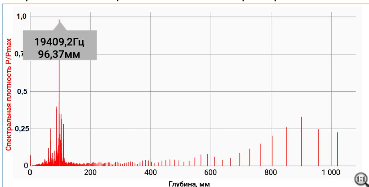
Рисунок 38 – Спектральная частотная характеристика сигнала с определением толщины объекта по максимальному соотношению  $P/P_{max}$
