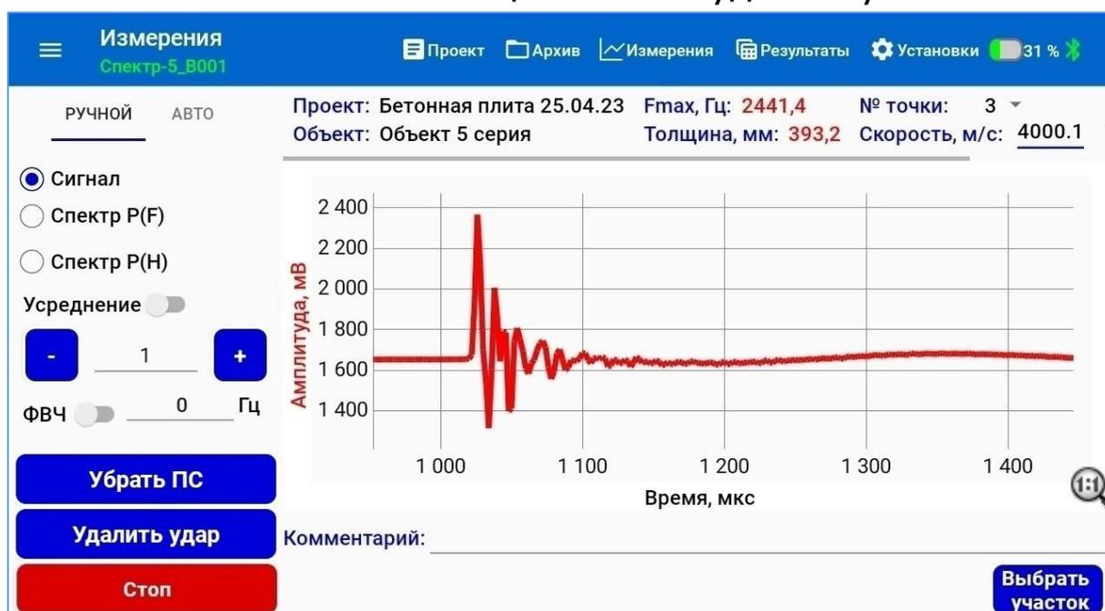
Рисунок 27 – Экран меню «Измерение». Записанный сигнал до включения инструмента «Убирать ПС»
