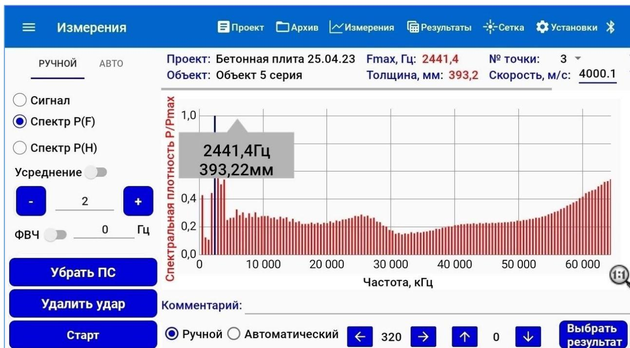
Рисунок 20 – Экран вывода графика спектральной плотности в рабочей полосе частот
