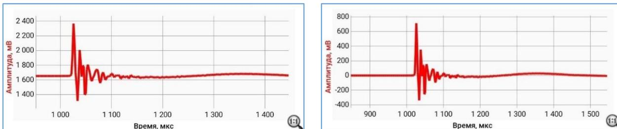
Рисунок 39 – Пример удаления постоянной составляющей
